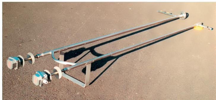
Перегреватель воздуха до 1000°С 16,5 кВт Стержни с очень высокопроизводительным нагревом 5 бар Поток: от 10 до 55 кг/час
