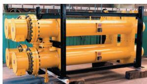
Подогрев топлива перед подачей в дизельный двигатель 1340 кВт, 460 В.
