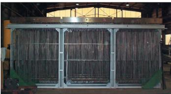
От -40° C до 20° C сборка канального воздухоосушителя -EXe - 6 x 2 м2 площадь теплообмена - Мощность 240 кВт
