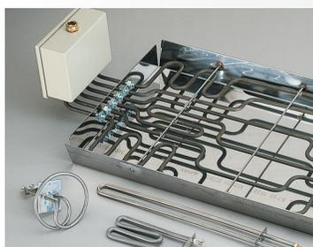
Инфракрасное излучение – довольно распространенный вид промышленного обогрева, который особенно подходит для нагрева движущихся объектов, например для печей обжига, печатных цехов и стерилизации. Поверхность нагревательных элементов обычных ИК-нагревателей может достигать 750 - 900°С и испускает волны среднего инфракрасного спектра от 2,82 мкм до 247 мкм.
