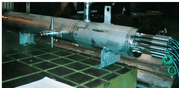
Циркуляционный нагреватель воздуха с потоком от 0,1 до 1 кг/с, нагреваемым до 1000°С 900 кВт 400 В давление 50 бар.
