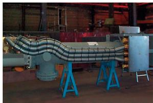
Испарение и регенерация азота на сталеплавильном заводе, 610 кВт
