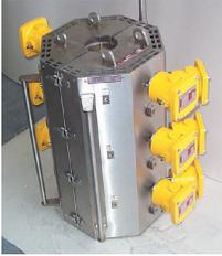
Формованные нагревательные элементы изготавливаются из алюминия, бронзы и латуни, используются с взрывозащищенными коробками подключения сертифицированного типа, с термостатом контроля температуры
