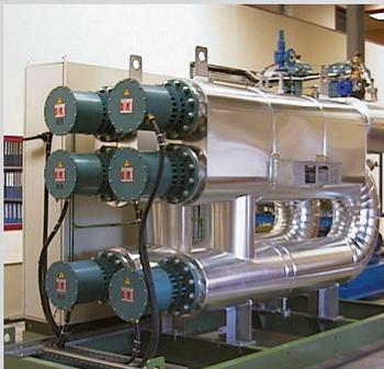
Циркуляционный нагреватель воздуха 400° С 300 кВт
