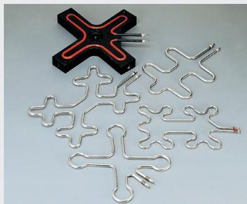
Эти элементы представляют собой очень хорошую альтернативу дубликатам нагревательных плит, особенно для нагрева распределителей с высокотемпературным каналом в индустрии пластмасс. Благодаря специальным условиям изготовления, используемым компанией Cetal, температура распределяется очень равномерно по всему формованному нагревательному элементу.
